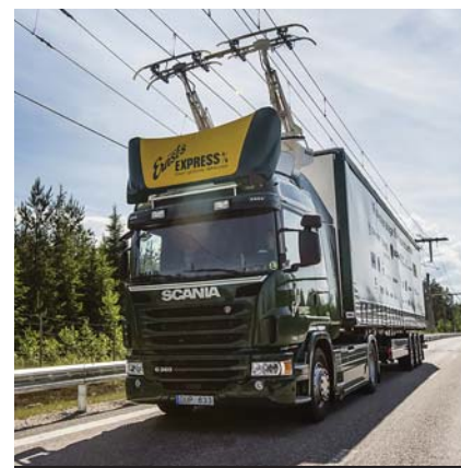
Hybrydowa ciężarówka Scania pracuje już na pierwszej na świecie, zelektryfikowanej autostradzie
